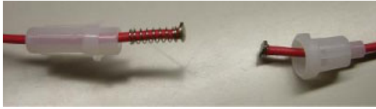
Fig. 4: ヒューズホルダの接続方法
