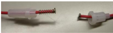
Fig. 3: ヒューズホルダの接続方法
