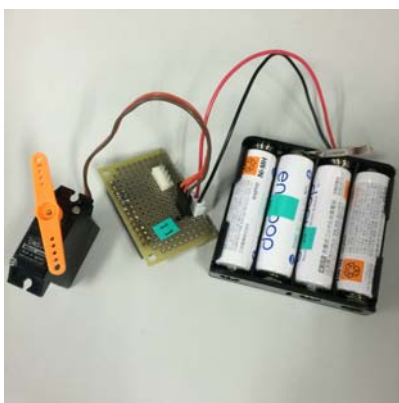
図. 5.7: RC サーボと接続用回路
