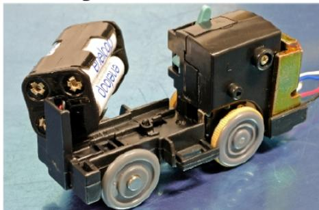
Fig. 17: 電池ボックスの搭載
