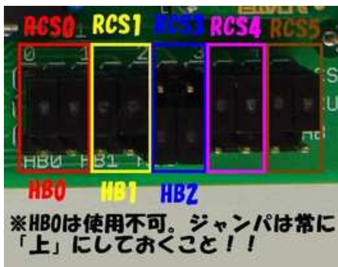
Fig. 4: モータドライブ回路／サーボモータ切り替えジャンパ
